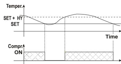
El relé del compresor se activa para mantener una determinada temperatura fijada por el set point. La histéresis Hy se suma automáticamente al set point. Si la temperatura aumenta y alcanza el set point más la histéresis, el compresor se activa, y se apaga luego cuando la temperatura vuelve al valor del set point. (vea la figura)
