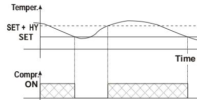
При повреждении датчика терmostата, пуск и остановка компрессора осуществляется по времени согласно параметрам "Con" и "Cof".
