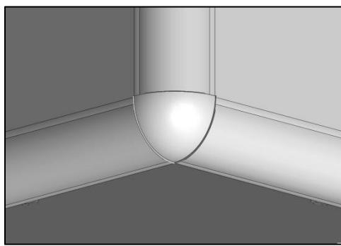
Placez le joint sanitaire dans le coin de la chambre pour obtenir une meilleure finition à l'intérieur.
