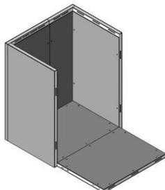
Dans le même ordre de montage que pour le premier côté, nous allons monter le côté avant, comme le montre l'image, en laissant 3 supports pour la pose du plafond (étape 6).
