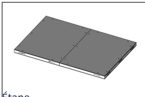
Placez les panneaux de sol selon la disposition indiquée sur le plan ci-joint et assemblez-les à l'aide du crochet. Certains panneaux de sol ont un sens, il faut donc veiller à bien aligner les boîtiers des crochets. Voir le plan de montage.
