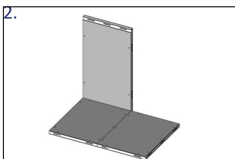
Réfléchissez bien au panneau vertical par lequel commencer le montage, en fonction de la configuration du local dans lequel nous allons installer la chambre. Nous recommandons de monter en dernier le côté où sera placée la porte.
