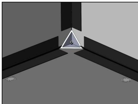
Placez les barres profilées sanitaires dans les coins de la chambre en laissant un espace de 35 mm sur le côté afin de pouvoir ensuite placer le noeud de jonction. Placez d'abord le profilé en L, puis clipsez le profilé sanitaire.
