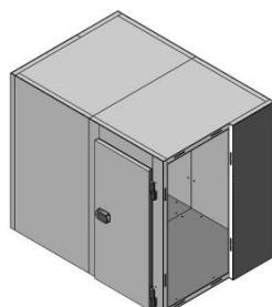
Placez le dernier côté de la chambre en vous assurant que tous les crochets sont correctement fermés et que les panneaux sont bien à niveau.
