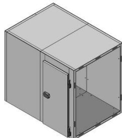
Terminez le montage de tous les « anneaux » restants jusqu'à ce qu'il ne reste plus que le dernier côté de la chambre à monter.
