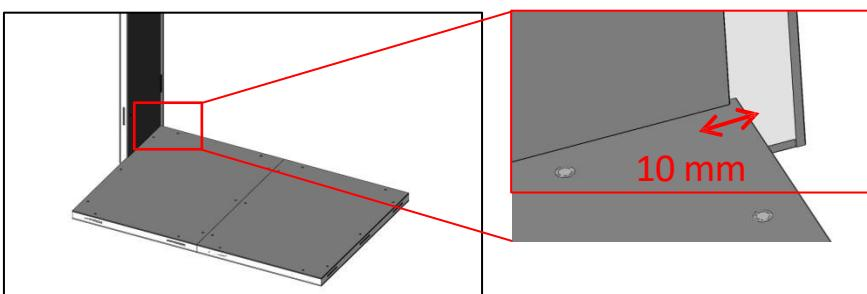
Si le premier panneau vertical que est un panneau d'angle, celui-ci doit être décalé de 10 mm par rapport au panneau de sol.
