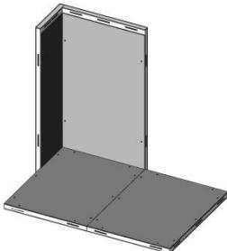
Nous allons placer le panneau vertical qui forme le coin avec le premier panneau posé. Comme mentionné précédemment, ne serrez pas les mécanismes excentriques tant que le panneau vertical n'est pas parfaitement aligné avec les autres panneaux.
